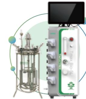
常规生物反应器 (Tmax Bio bioreactor) 是实验室或工业上对工程菌株进行发酵,验证其生产能力的装置。罐体体积1-7L可选,由通气系统、搅拌系统、温度控制系统、pH控制系统、溶氧控制系统、补料系统和操作软件等几部分组成,参数控制稳定,能更好的帮用户验证菌株生产性能,快速确定放大工艺。
