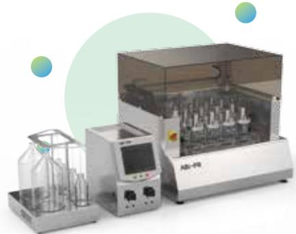
高通量自动配料仪(Automatic Batching Instrument for Parallel Reactor, ABI-PR)可对0.2~10L发酵体系进行多通道同时自动配料、料液分装的设备。该设备具有全自动,多通道,高精度,多规格容器适配,配料方案灵活编辑,支持容器数据共享,操作稳定性高等特点,可以有效降低配料过程的人力成本,保证配料精度。
