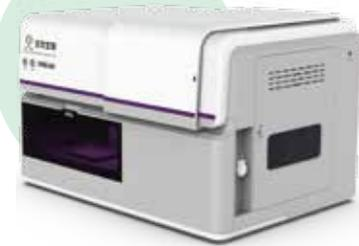
高通量微升级液滴培养组学系统 (Single-cell Microliter-droplet Culture Omics System, MISS cell culture omics) 是基于液滴微流控技术开发的微型化高通量单细胞培养及分选装备, 单次运行实验可以处理约 5000-20000 个液滴 (500-4000 个单克隆), 液滴生成后存储于高透气性管路中进行孵育 (0-60 天), 最后通过光学信号 (OD、荧光、化学发光等) 进行检测分选, 实现对环境菌群在单细胞水平上的分离培养, 将目标液滴分选保存至多孔板中。
