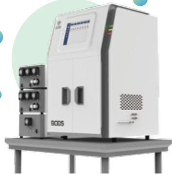
生物培养过程在线检测仪 (Bioreaction Online Detection System, BODS) 是一种对生物反应器进行全自动在线取样、处理、检测和留样的仪器。多种检测模块集成, 可实时显示罐内生物量、底物消耗和产物生成情况, 也可及时调节反馈控制系统, 实现底物的精确控制流加, 提高发酵过程控制效率, 为发酵过程优化和工艺放大提供强有力的数据支撑。
